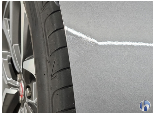
1. Achterbumper Gebruikssporen - Aanvaardbaar
