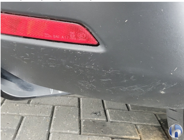
2. Achterbumper Schaafplek - Spot Repair/Deelreparatie
