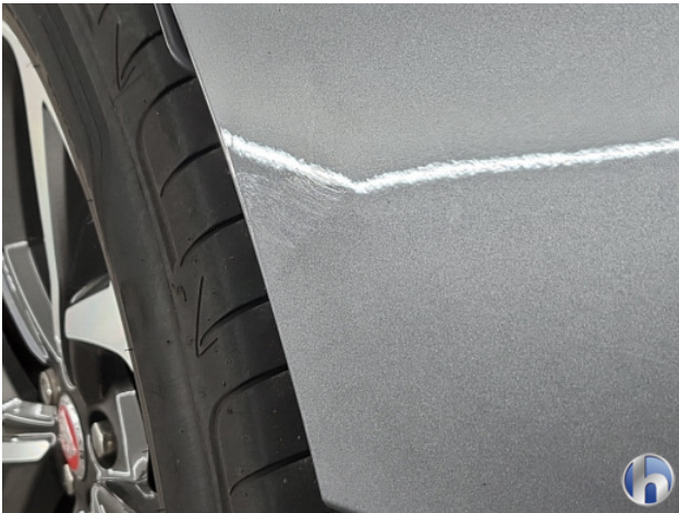
1. Achterbumper Gebruikssporen - Aanvaardbaar
