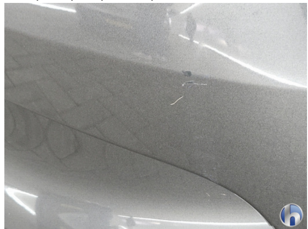
2. Achterbumper Schaafplek - Spot Repair/Deelreparatie
