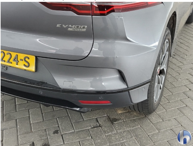
2. Achterbumper Schaafplek - Spot Repair/Deelreparatie
