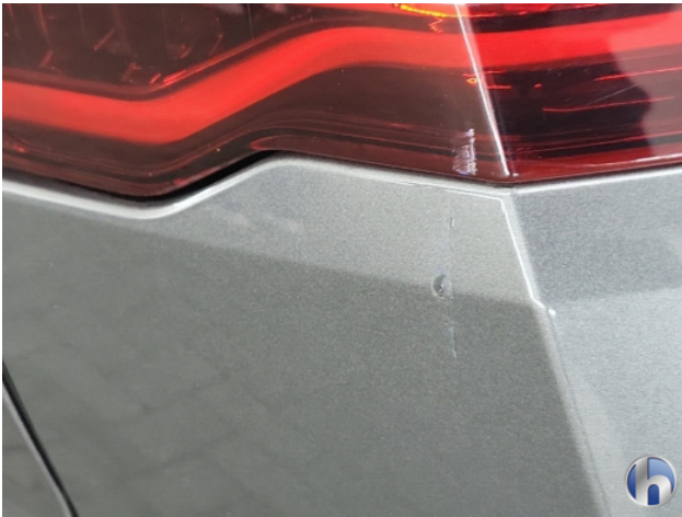
2. Achterbumper Schaafplek - Spot Repair/Deelreparatie
