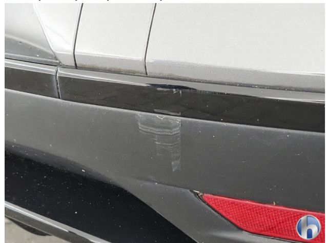
2. Achterbumper Schaafplek - Spot Repair/Deelreparatie
