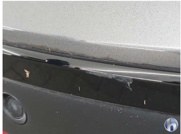
2. Achterbumper Schaafplek - Spot Repair/Deelreparatie
