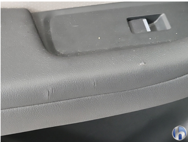
4. deurbekleding linksachter Beschadigd - Herstellen
