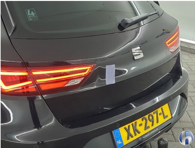
1. Achterklep Deuk/deuken - Herstellen
