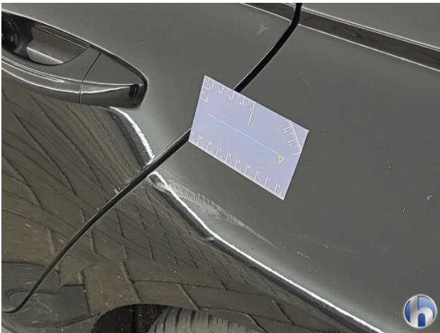
3. Diverse delen Beschadigd - Voorbereiden / polijsten
