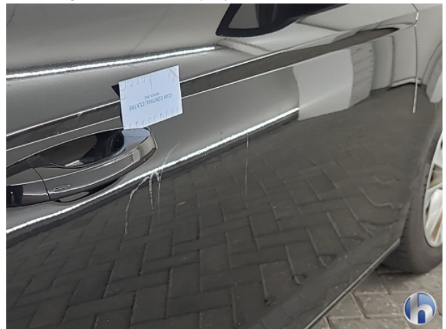
3. Diverse delen Beschadigd - Voorbereiden / polijsten
