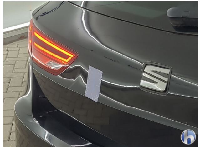
1. Achterklep Deuk/deuken - Herstellen
