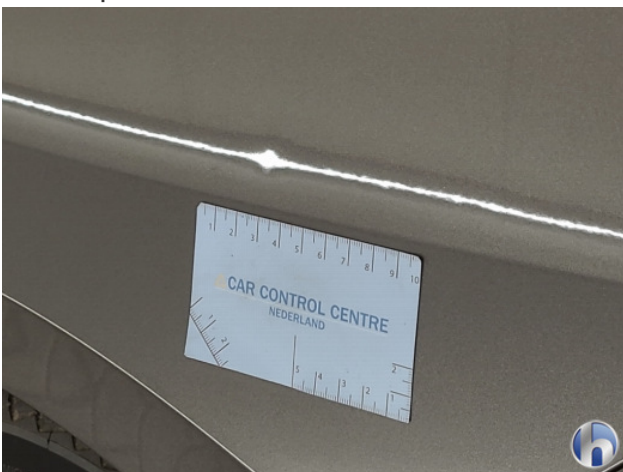
1. diverse Gebruikssporen - Aanvaardbaar
