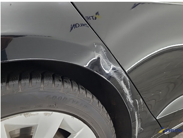
2. Zijwand - achter - rechts Deuk/deuken
