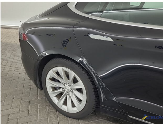
2. Zijwand - achter - rechts Deuk/deuken
