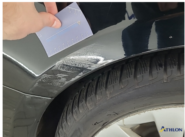
2. Zijwand - achter - rechts Deuk/deuken
