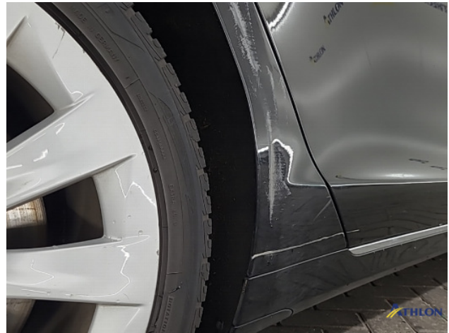
2. Zijwand - achter - rechts Deuk/deuken
