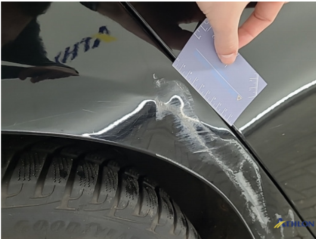
2. Zijwand - achter - rechts Deuk/deuken
