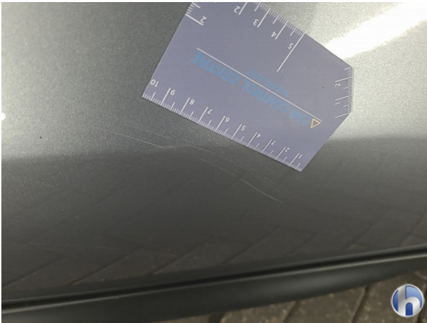
1. Diverse Gebruikssporen - Aanvaardbaar
