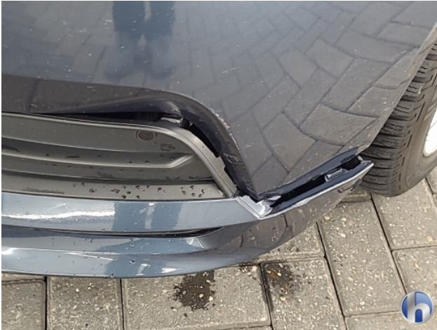
1. Voorbumper Schaafplek - Spot Repair/Deelreparatie
