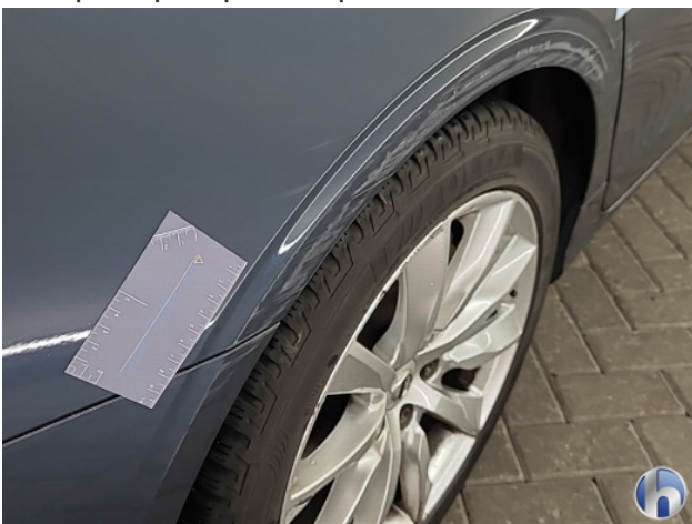
2. Zijwand - achter - rechts Schaafplek - Spot Repair/Deelreparatie
