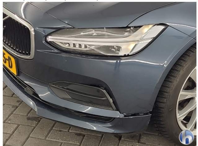
1. Voorbumper Schaafplek - Spot Repair/Deelreparatie
