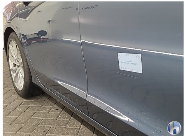
2. Zijwand - achter - rechts Schaafplek - Spot Repair/Deelreparatie
