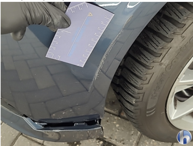
1. Voorbumper Schaafplek - Spot Repair/Deelreparatie
