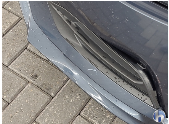
1. Voorbumper Schaafplek - Spot Repair/Deelreparatie
