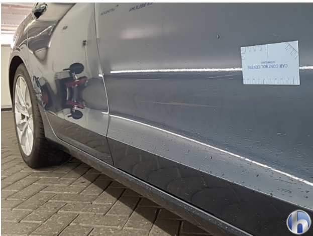
2. Zijwand - achter - rechts Schaafplek - Spot Repair/Deelreparatie
