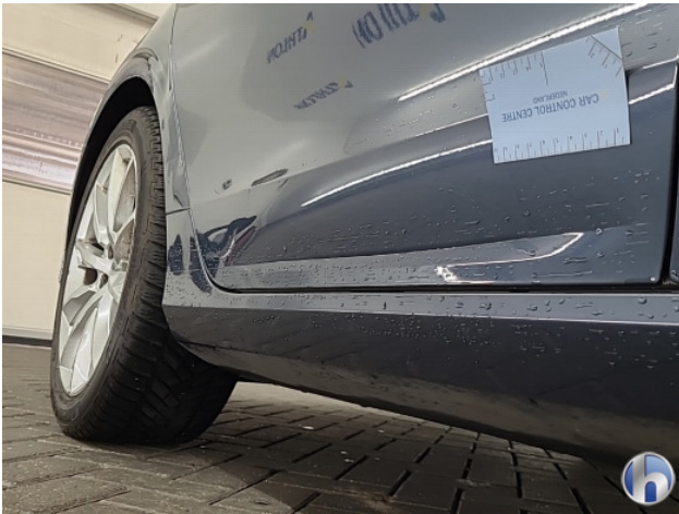
2. Zijwand - achter - rechts Schaafplek - Spot Repair/Deelreparatie
