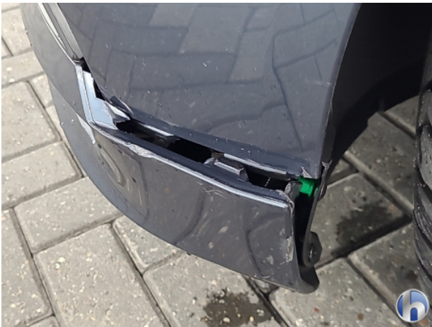
1. Voorbumper Schaafplek - Spot Repair/Deelreparatie
