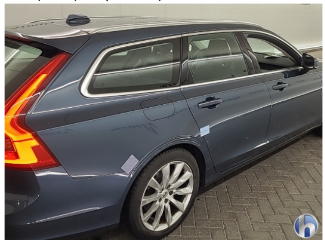
2. Zijwand - achter - rechts Schaafplek - Spot Repair/Deelreparatie
