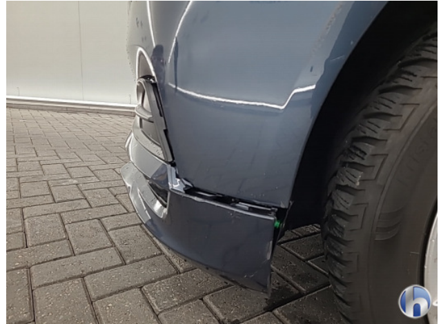
1. Voorbumper Schaafplek - Spot Repair/Deelreparatie
