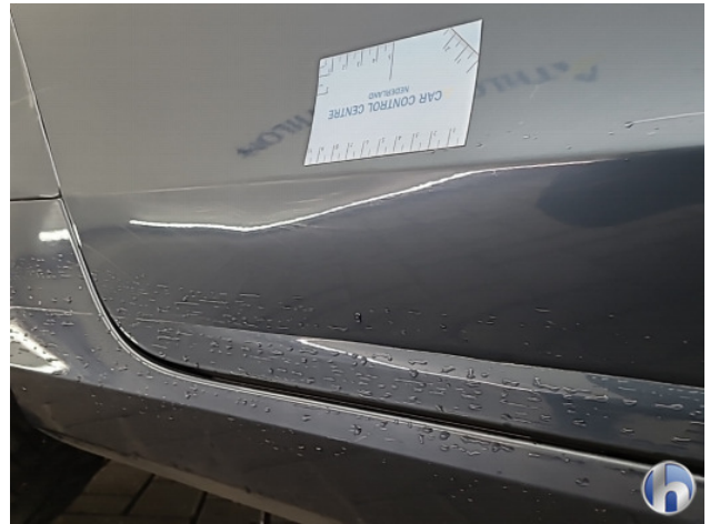
2. Zijwand - achter - rechts Schaafplek - Spot Repair/Deelreparatie
