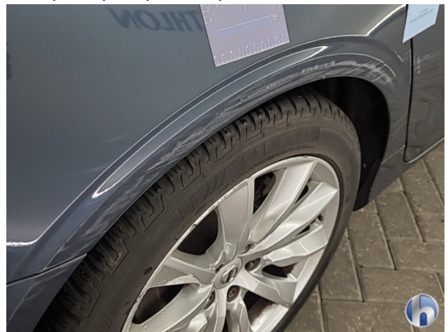
2. Zijwand - achter - rechts Schaafplek - Spot Repair/Deelreparatie
