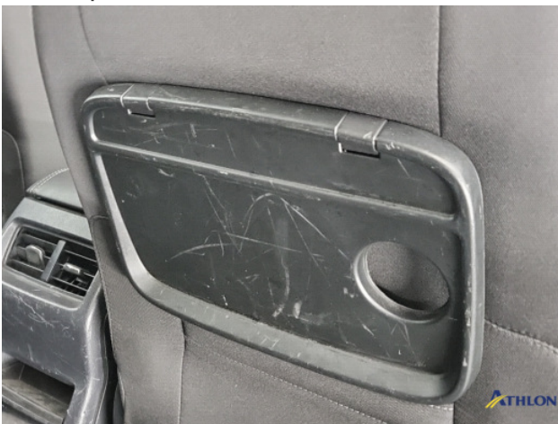
7. diverse interieur Beschadigd
