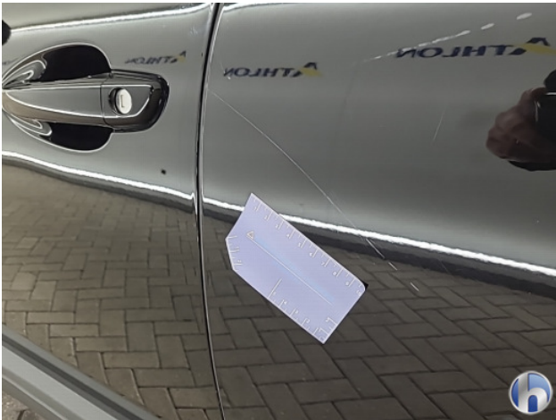
1. diverse schades Gebruikssporen - Aanvaardbaar
