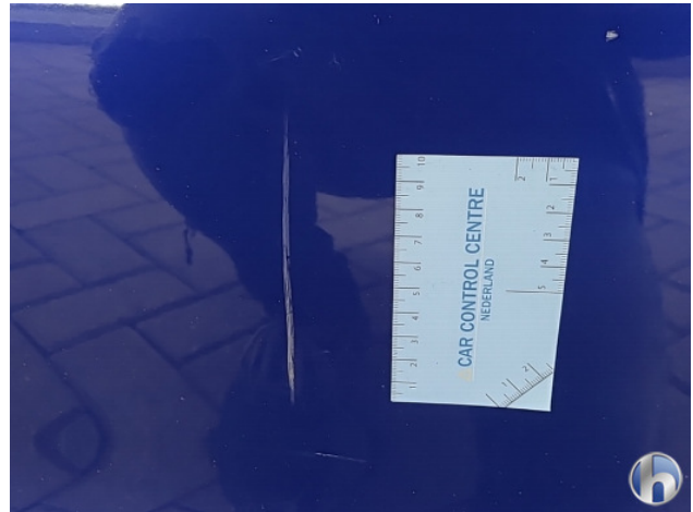
1. Portier voor - links Gebruikssporen - Aanvaardbaar
