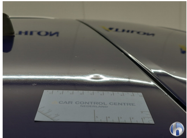
5. diverse Gebruikssporen - Aanvaardbaar
