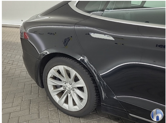
2. Zijwand - achter - rechts Deuk/deuken - Herstellen
