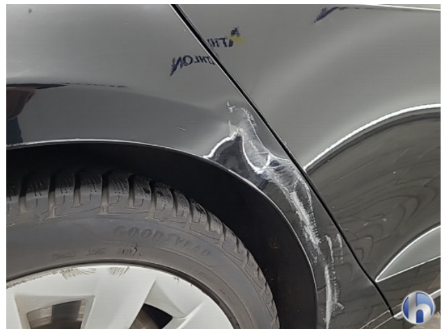
2. Zijwand - achter - rechts Deuk/deuken - Herstellen
