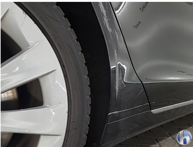
2. Zijwand - achter - rechts Deuk/deuken - Herstellen
