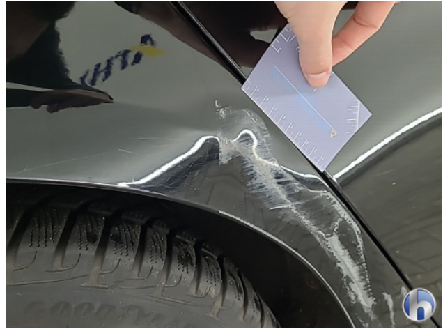
2. Zijwand - achter - rechts Deuk/deuken - Herstellen
