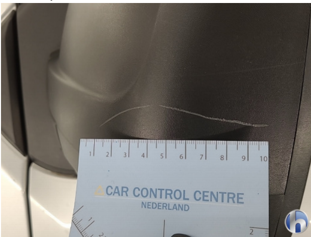
2. Spiegelbehuizing - links Gebruikssporen - Aanvaardbaar
