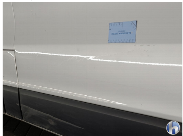
1. Zijwand - achter - Links Gebruikssporen - Aanvaardbaar
