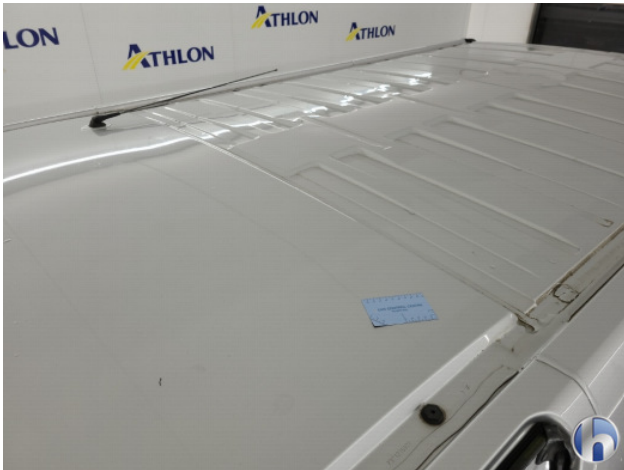
1. Dak Deuk/deuken - Spot Repair/Deelreparatie
