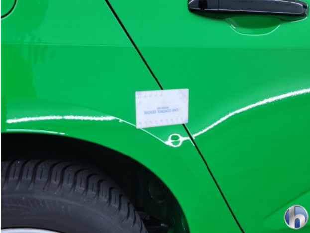
1. diverse andere Gebruikssporen - Aanvaardbaar
