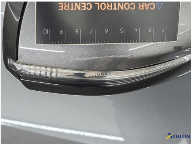
5. Spiegelbehuizing - rechts Gebruikssporen
