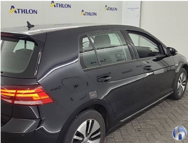
2. Zijwand - achter - rechts Krassen - Spuiten
