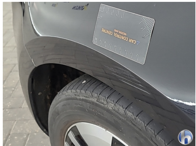
2. Zijwand - achter - rechts Krassen - Spuiten
