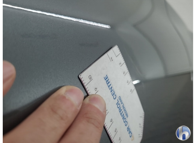
1. Portier voor - rechts Gebruikssporen - Aanvaardbaar
