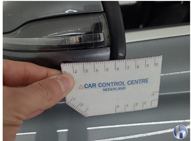
2. diverse Gebruikssporen - Aanvaardbaar
