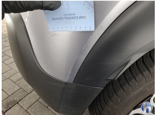
1. diverse Gebruikssporen - Aanvaardbaar
