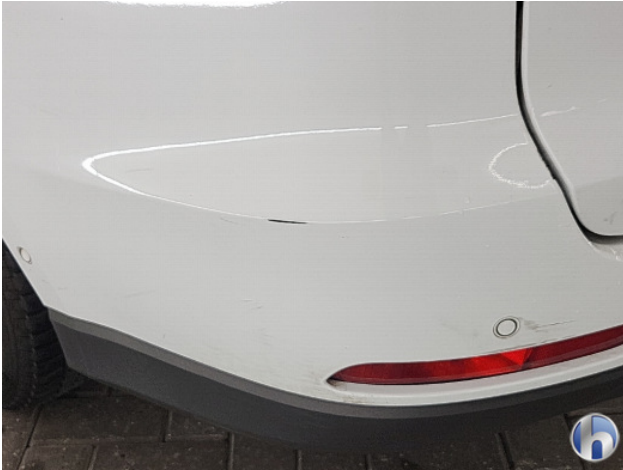
1. Achterbumper Gebruikssporen - Aanvaardbaar
