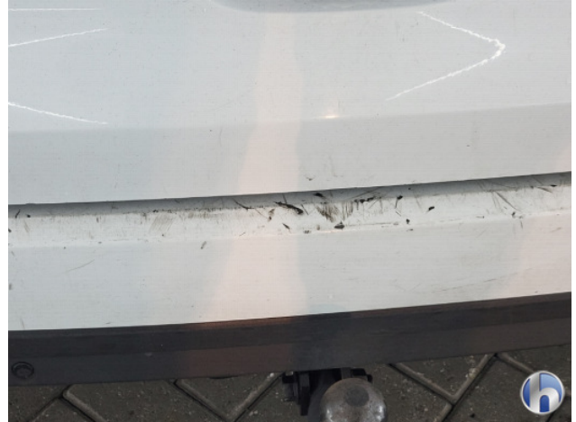
1. Achterbumper Gebruikssporen - Aanvaardbaar
