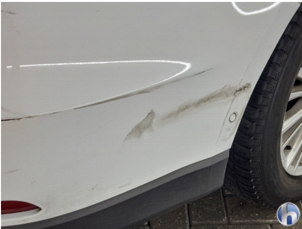
2. Achterbumper Gebruikssporen - Aanvaardbaar
