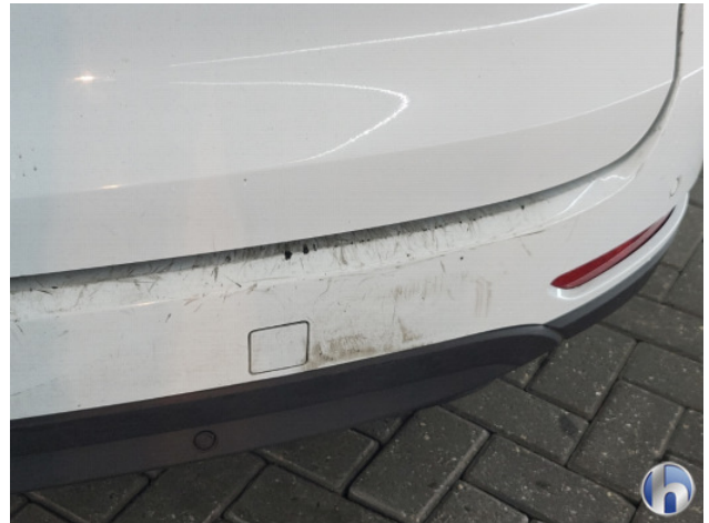
1. Achterbumper Gebruikssporen - Aanvaardbaar
