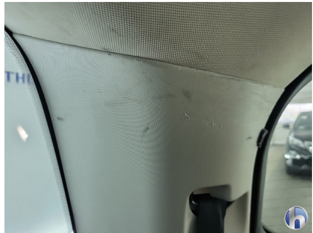
3. diverse interieur Beschadigd - Vernieuwen
