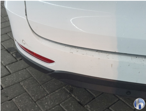
1. Achterbumper Gebruikssporen - Aanvaardbaar
