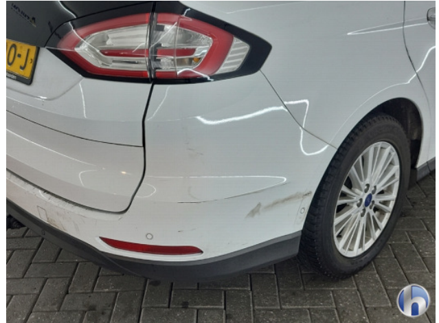
2. Achterbumper Gebruikssporen - Aanvaardbaar
