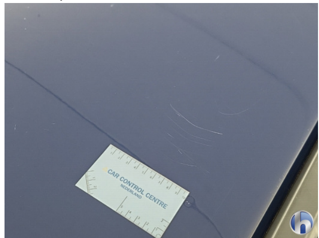
3. Dak Krassen - Spuiten
