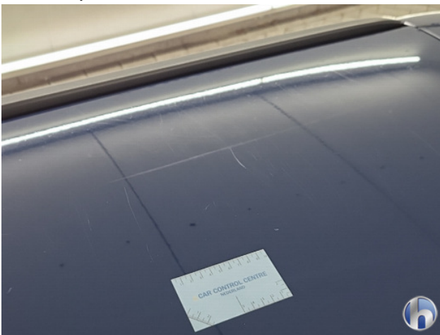
3. Dak Krassen - Spuiten
