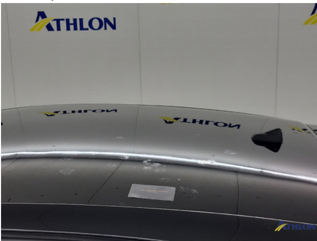
6. ingebrande vogelpoep Beschadigd
