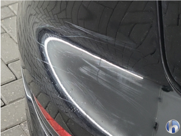
1. Achterbumper Gebruikssporen - Aanvaardbaar
