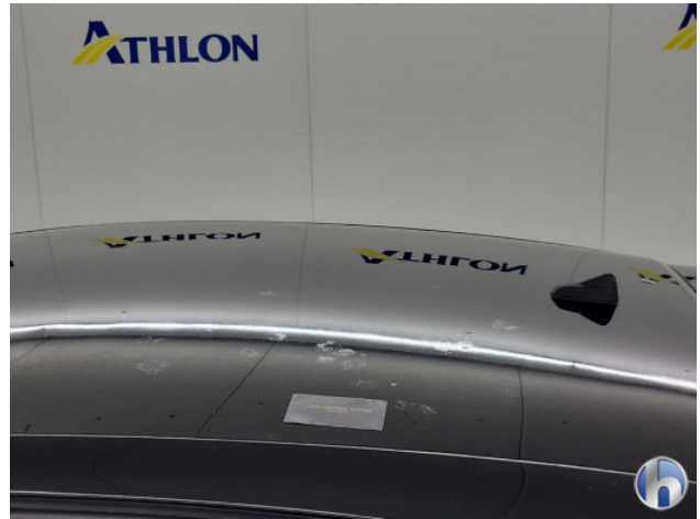
5. ingebrande vogelpoep Beschadigd - Spuiten
