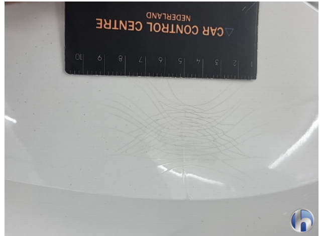
1. Achterbumper Barst - Spot Repair/Deelreparatie
