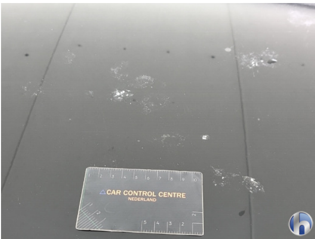
5. ingebrande vogelpoep Beschadigd - Spuiten
