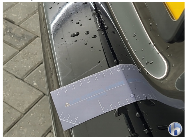
1. Diverse Gebruikssporen - Aanvaardbaar
