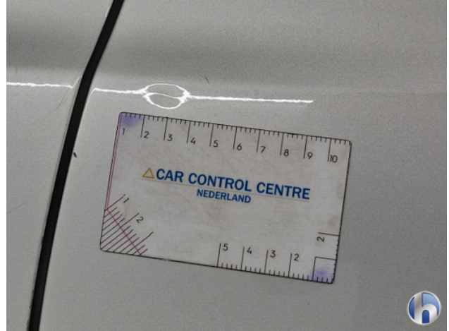
1. diverse Gebruikssporen - Aanvaardbaar
