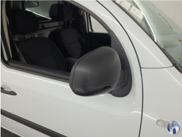
4. Spiegelbehuizing - rechts Breuk / barst / scheur - Vernieuwen
