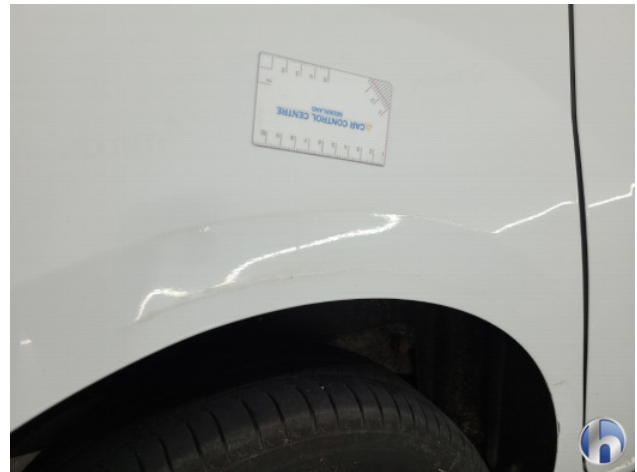
2. Zijwand - achter - rechts Schaafplek - Herstellen
