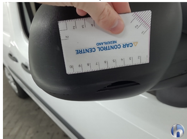
4. Spiegelbehuizing - rechts Breuk / barst / scheur - Vernieuwen
