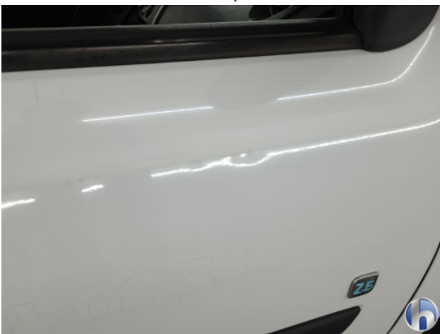
3. Portier voor - rechts Deuk/deuken - Herstellen zonder spuiten
