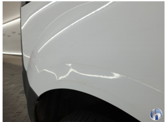
2. Zijwand - achter - rechts Schaafplek - Herstellen
