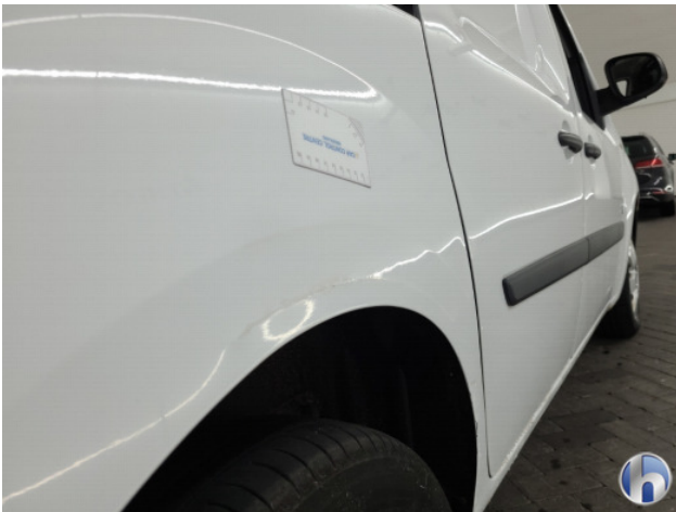
2. Zijwand - achter - rechts Schaafplek - Herstellen
