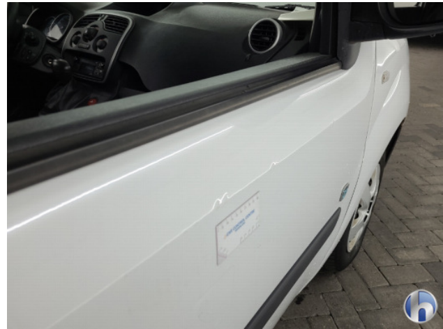
3. Portier voor - rechts Deuk/deuken - Herstellen zonder spuiten
