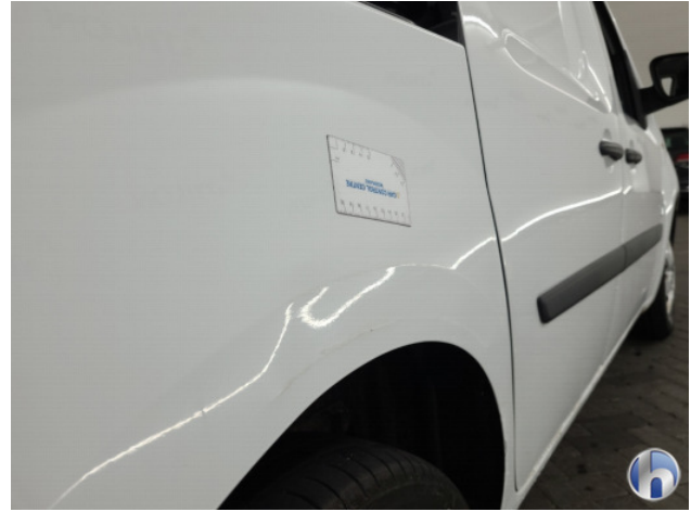
2. Zijwand - achter - rechts Schaafplek - Herstellen
