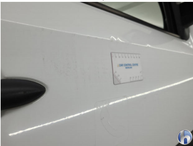
3. Portier voor - rechts Deuk/deuken - Herstellen zonder spuiten
