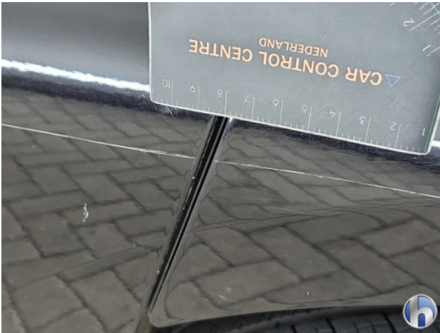
1. Portier achter - links Krassen - Spuiten
