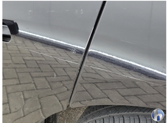
1. Portier achter - links Krassen - Spuiten
