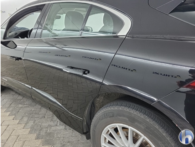
1. Portier achter - links Krassen - Spuiten
