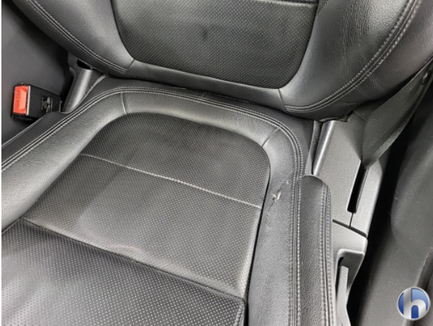
1. Stoel - voor - links: zitting Gebruikssporen - Aanvaardbaar
