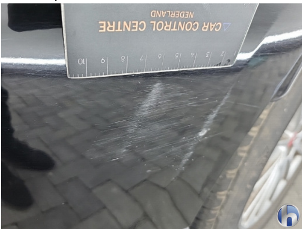
3. Achterbumper Schaafplek - Spot Repair/Deelreparatie
