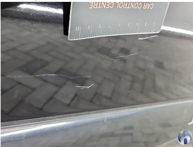
4. Portier achter - rechts Krassen - Spuiten
