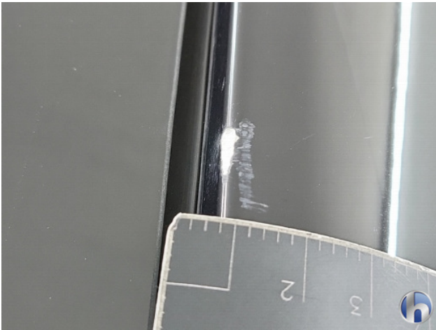
2. diverse Gebruikssporen - Aanvaardbaar
