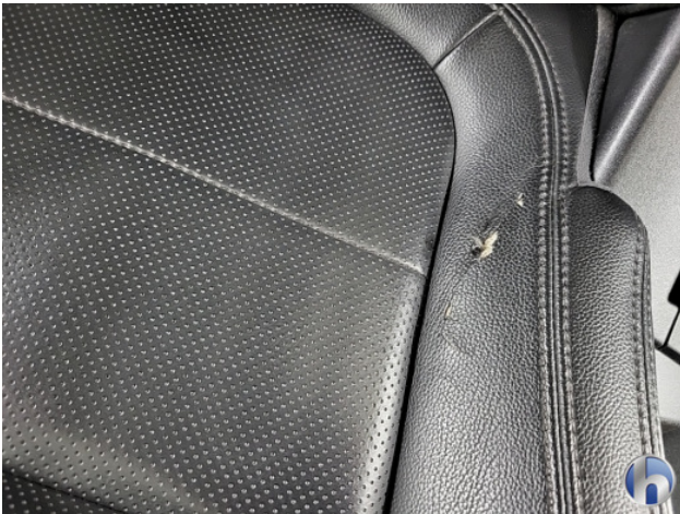
1. Stoel - voor - links: zitting Gebruikssporen - Aanvaardbaar
