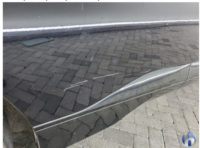
4. Portier achter - rechts Krassen - Spuiten
