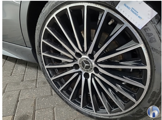
2. Velg (aluminium) achter - links Beschadigd - Herstellen
