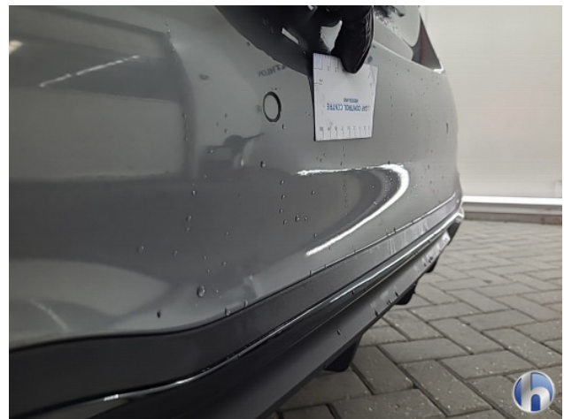
3. Achterbumper Breuk / barst / scheur - Herstellen
