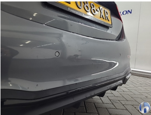
3. Achterbumper Breuk / barst / scheur - Herstellen
