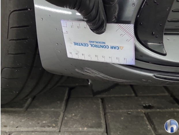
1. Voorbumper Schaafplek - Spot Repair/Deelreparatie
