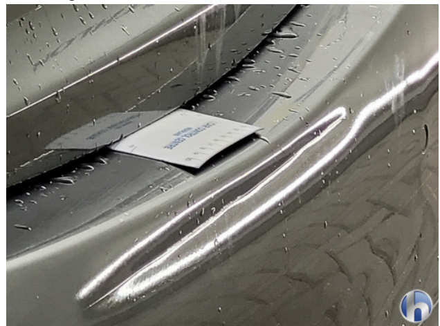
3. Achterbumper Breuk / barst / scheur - Herstellen
