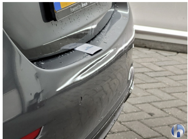
3. Achterbumper Breuk / barst / scheur - Herstellen
