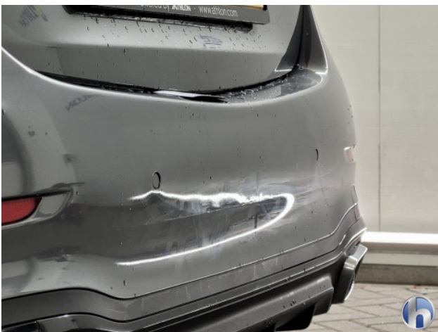
3. Achterbumper Breuk / barst / scheur - Herstellen
