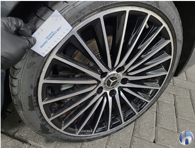
2. Velg (aluminium) achter - links Beschadigd - Herstellen
