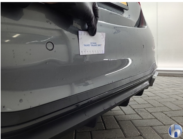
3. Achterbumper Breuk / barst / scheur - Herstellen
