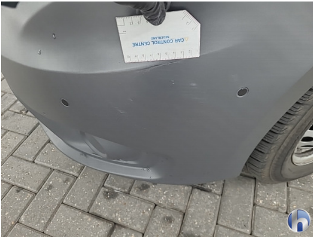
1. Diverse Gebruikssporen - Aanvaardbaar
