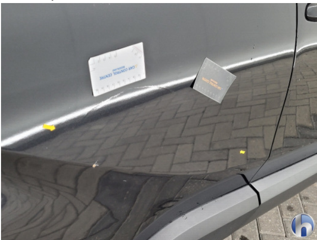
3. slecht herstel Gebruikssporen - Aanvaardbaar
