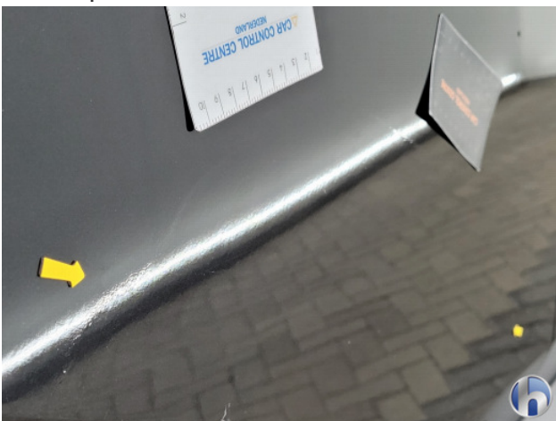
3. slecht herstel Gebruikssporen - Aanvaardbaar
