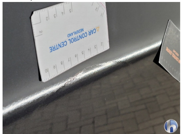
3. slecht herstel Gebruikssporen - Aanvaardbaar
