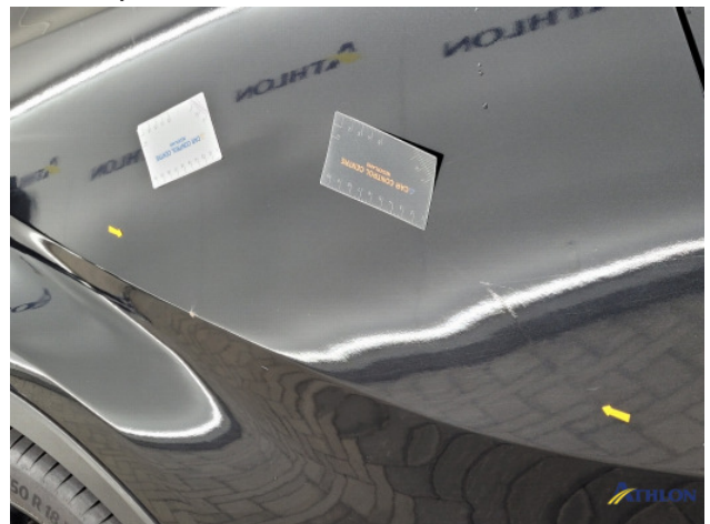
3. slecht herstel Gebruikssporen
