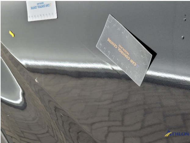
3. slecht herstel Gebruikssporen
