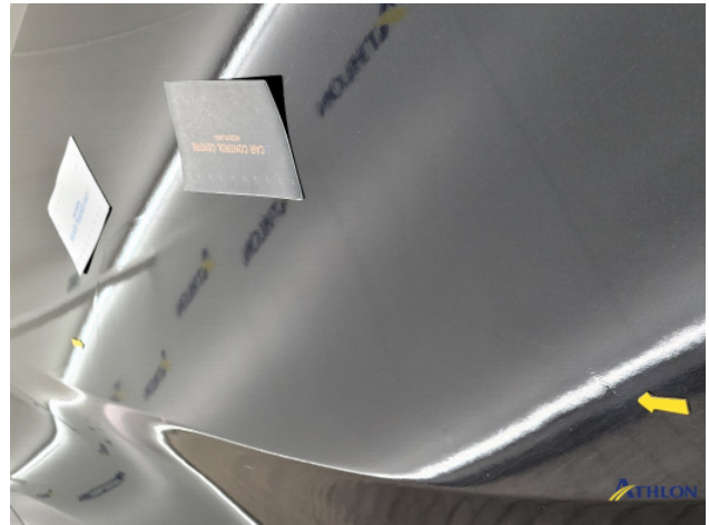
3. slecht herstel Gebruikssporen
