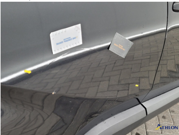
3. slecht herstel Gebruikssporen
