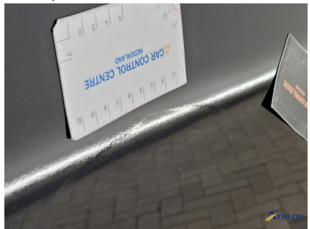
3. slecht herstel Gebruikssporen
