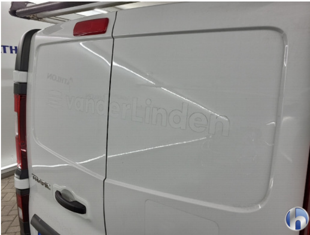
1. Ontstickerresten Gebruikssporen - Aanvaardbaar
