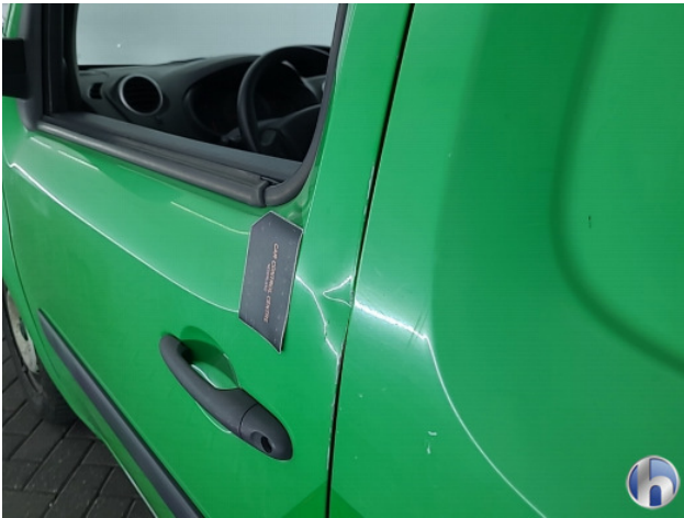
2. Portier voor - links Deuk/deuken - Herstellen
