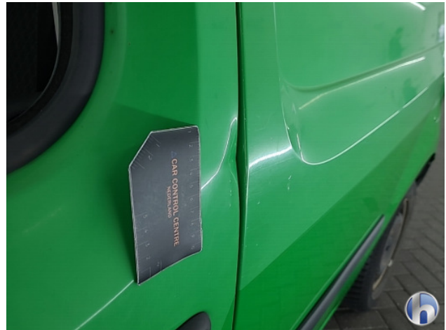
2. Portier voor - links Deuk/deuken - Herstellen
