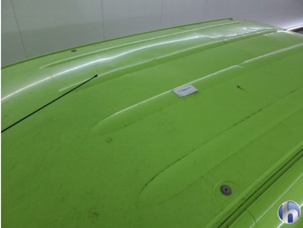
1. Dak Deuk/deuken - Herstellen
