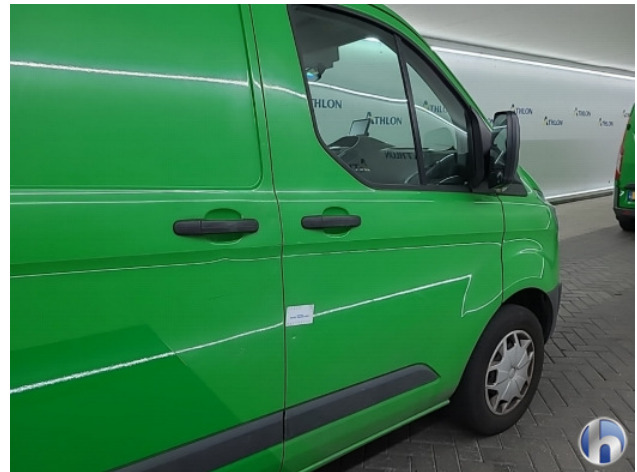
2. diverse Gebruikssporen - Aanvaardbaar
