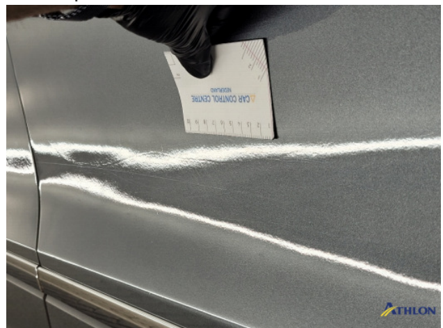
2. Slecht herstel Gebruikssporen
