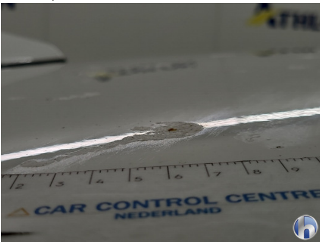
1. diverse Gebruikssporen - Aanvaardbaar
