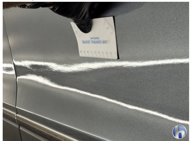
2. Slecht herstel Gebruikssporen - Aanvaardbaar
