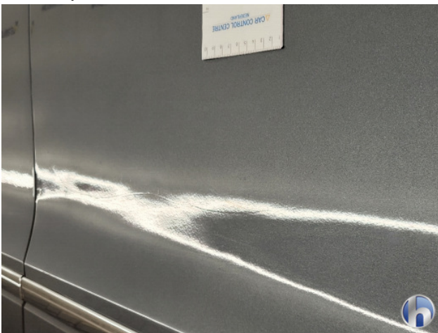
2. Slecht herstel Gebruikssporen - Aanvaardbaar
