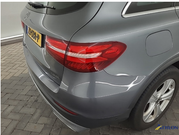
6. Achterlicht rechts Krassen
