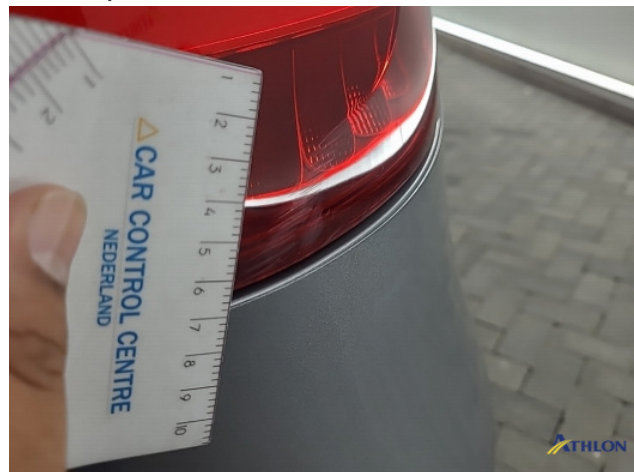
6. Achterlicht rechts Krassen
