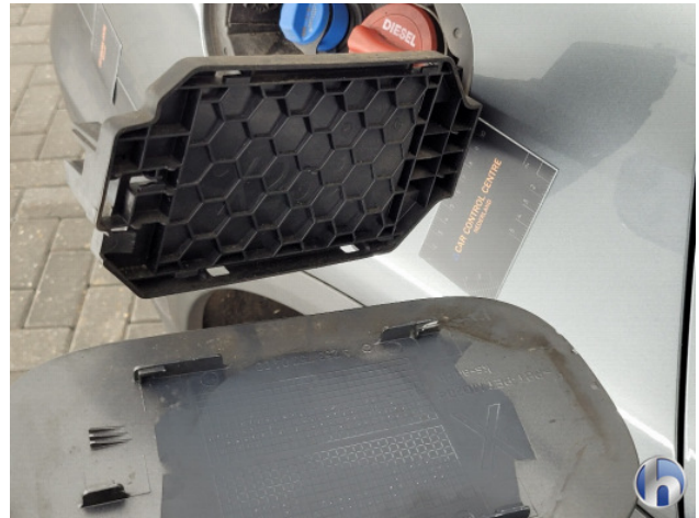
5. Tankklep Beschadigd - Vernieuwen
