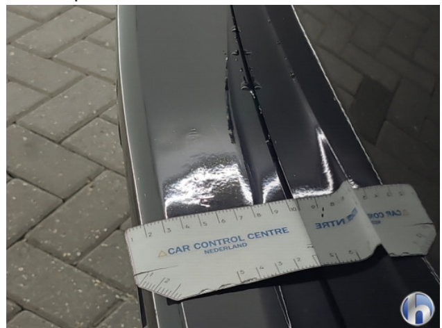
2. Achterbumper Gebruikssporen - Aanvaardbaar
