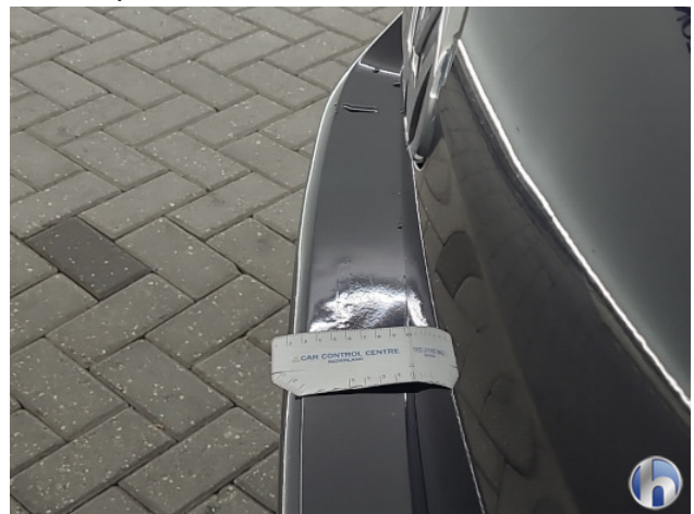
2. Achterbumper Gebruikssporen - Aanvaardbaar
