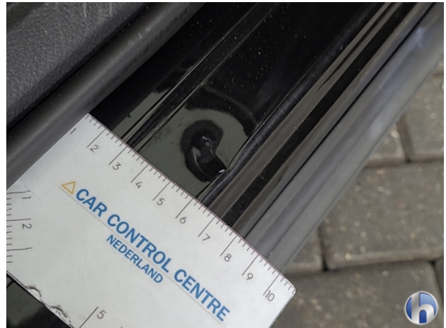
1. Diverse Gebruikssporen - Aanvaardbaar
