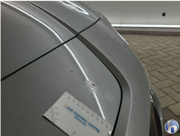
1. Diverse Gebruikssporen - Aanvaardbaar
