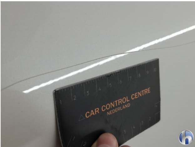
1. diverse Gebruikssporen - Aanvaardbaar
