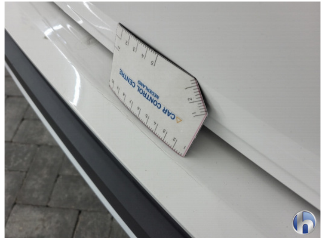
1. Achterbumper Gebruikssporen - Aanvaardbaar
