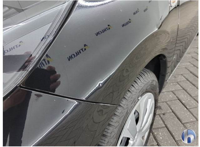
1. Diverse Gebruikssporen - Aanvaardbaar
