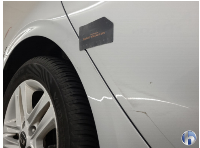
1. diverse Gebruikssporen - Aanvaardbaar
