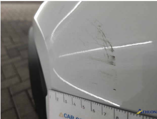
1. Voorscher - links Breuk / barst / scheur
