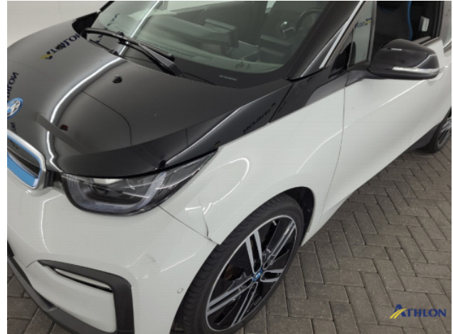
1. Voorscher - links Breuk / barst / scheur
