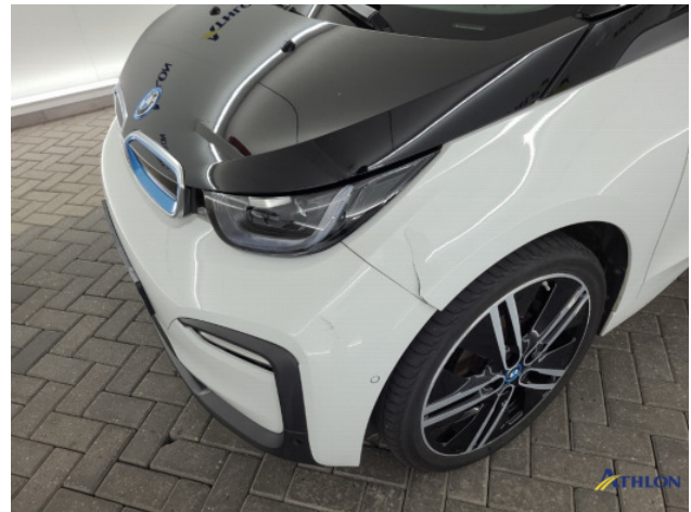
1. Voorscher - links Breuk / barst / scheur
