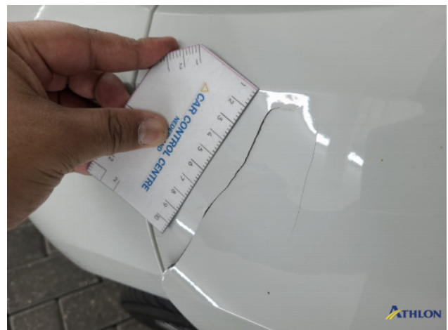
1. Voorscherm - links Breuk / barst / scheur
