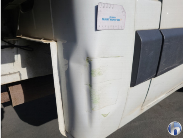
1. Portier voor - rechts Deuk/deuken - Herstellen
