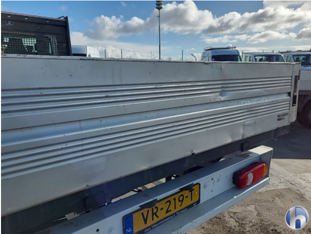
5. Achterklep Deuk/deuken - Herstellen
