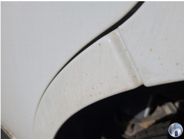
7. Roest rondom Beschadigd - Voorbereiden / polijsten
