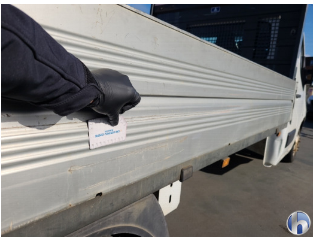
5. Achterklep Deuk/deuken - Herstellen
