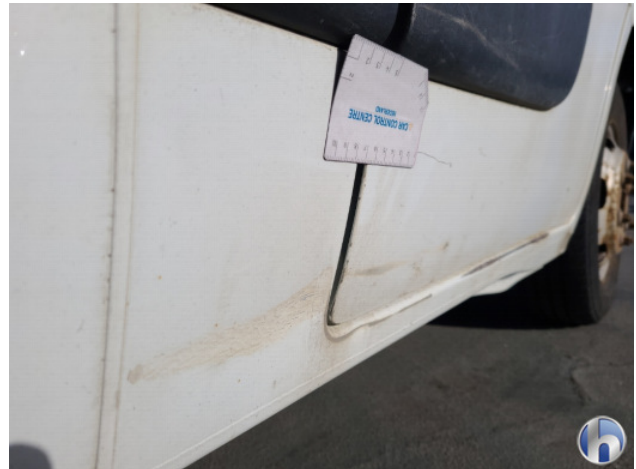
1. Portier voor - rechts Deuk/deuken - Herstellen
