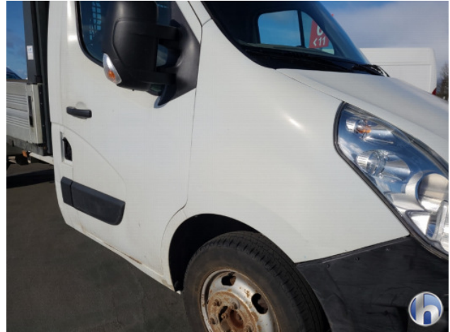
7. Roest rondom Beschadigd - Voorbereiden / polijsten
