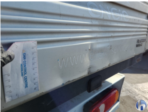
5. Achterklep Deuk/deuken - Herstellen
