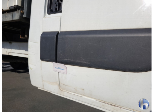
1. Portier voor - rechts Deuk/deuken - Herstellen
