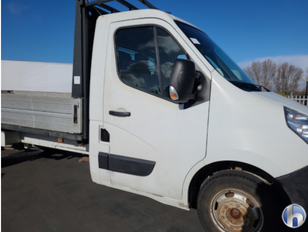
1. Portier voor - rechts Deuk/deuken - Herstellen
