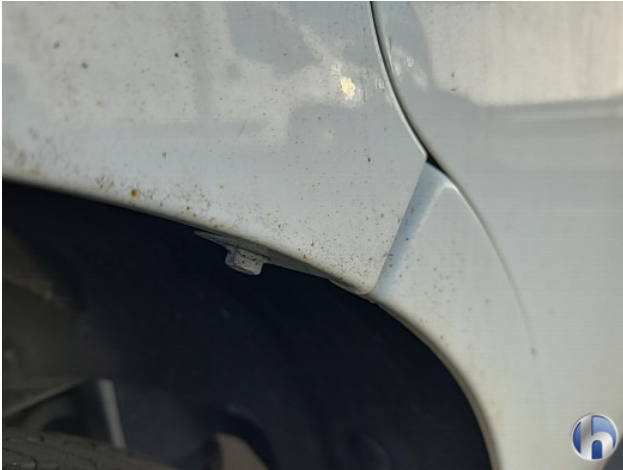
7. Roest rondom Beschadigd - Voorbereiden / polijsten
