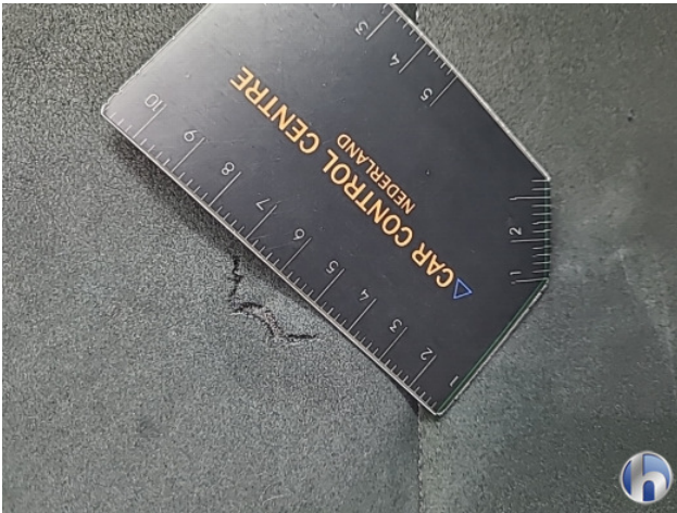
2. diverse interieurdelen Beschadigd - Vernieuwen
