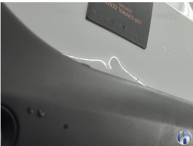
4. Achterklep Deuk/deuken - Herstellen
