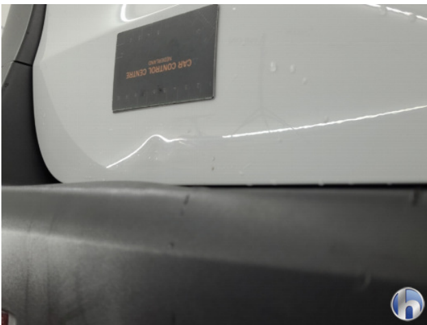
4. Achterklep Deuk/deuken - Herstellen
