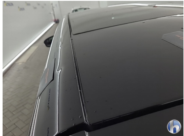
1. Motorkap Hagelschade - Herstellen zonder spuiten
