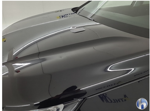
1. Motorkap Hagelschade - Herstellen zonder spuiten
