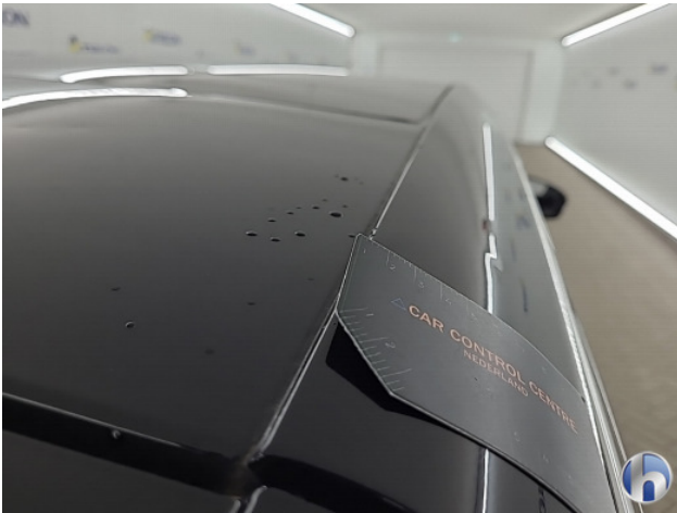
1. Motorkap Hagelschade - Herstellen zonder spuiten
